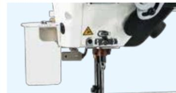
縫製中の針折れの飛散を防ぎます。アイガードが開いているとミシンが動かない為、針交換時に電源を切り忘れてもミシンは動作せず安心です。
