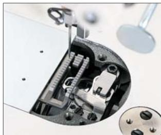
動メスと固定メスによる安定した糸切り機構で、細糸から#8までの太糸を確実に、スピーディにカットします。
